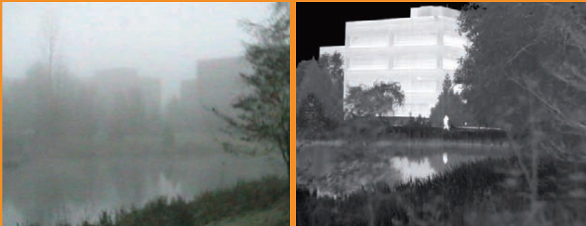
A sinistra, l'immagine catturata da una telecamera in una giornata di nebbia intensa; a destra la stessa immagine ripresa da una termocamera FLIR, con rilevazione di un individuo
