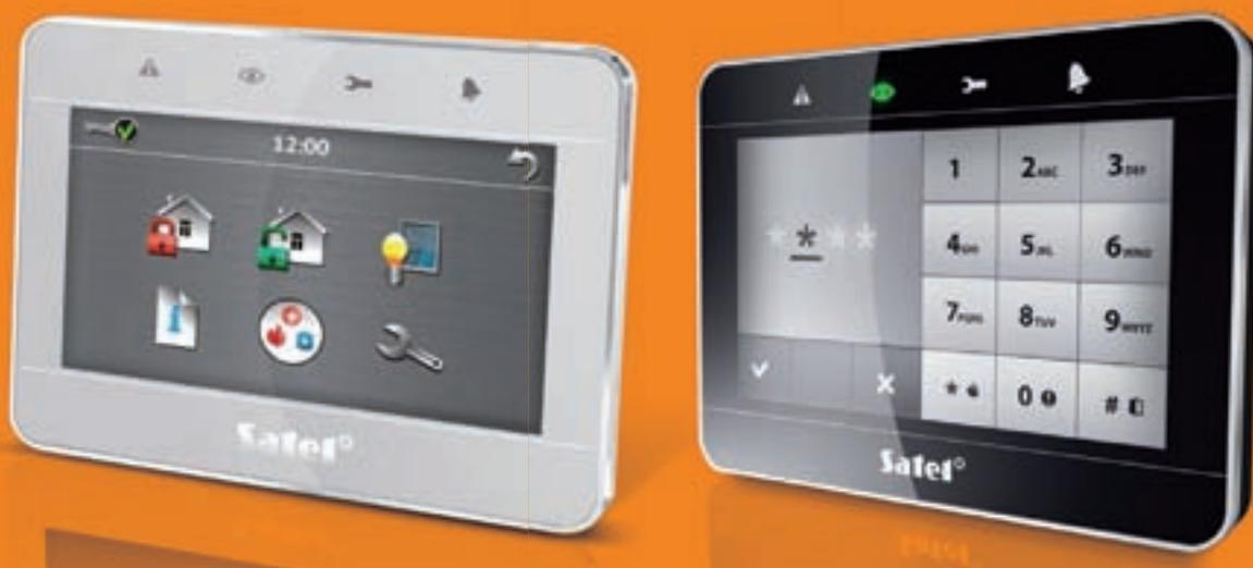
La tastiera, collegata al BUS Satel, ha due zone a bordo e viene programmata direttamente dal software Dloadx, che si utilizza per la configurazione di qualsiasi altra tastiera Satel, quindi senza necessità di software dedicato. I due ingressi filari possono gestire dei rilevatori di tipo NO e NC e dei contatti a fune per tapparella e di vibrazione, inoltre gestiscono delle configurazioni EOL, 2EOL e 3EOL con la programmazione dei valori delle resistenze di bilanciamento.
