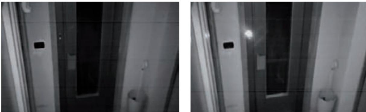
**Figura 2:** La telecamera in modalità night. Una persona, in un piano diverso da quello sorvegliato, accende le luci della scala e chiama l'ascensore. La differenza di luminosità complessiva della scena genera un falso allarme.
