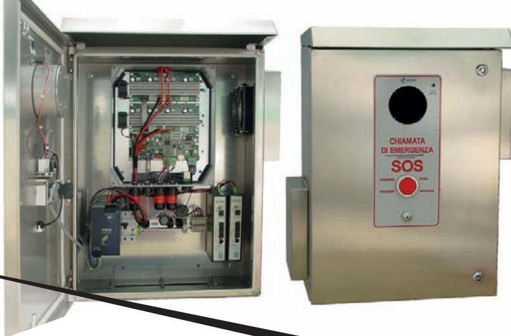
■ **7 gateway Over IP da 320W, ciascuno che pilota 16 trombe da 20W e interfaccia un Help Point. Gateway audio, help point, modem VDSL e alimentatori sono assemblati in un armadio inox per fissaggio a palo**
